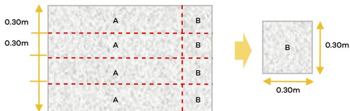
**2** Unir las planchas cortadas A y B ,y fijarlas, hacer toda la instalación eléctrica de los focos de alumbrado dentro de la caja armada
