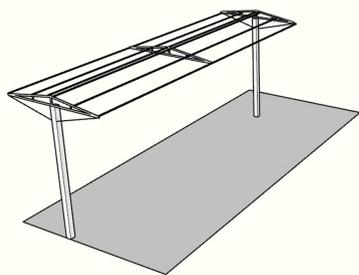
**4** Colocar y fijar las coberturas con tornillos según el tipo de estructura , por ultimo colocar la cumblera en la unión de las dos caídas.
