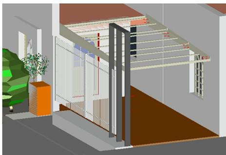
**4** Paso 04: Emplaque la estructura para drywall con placas de fibrocemento ETERBOARD.
