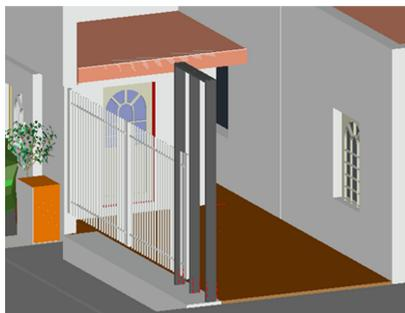
**3** Paso 03: Fije la estructura de techo corredizo con anclajes a la pared y a la estructura reforzada para drywall.
